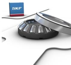
Dans les butées à rotule sur rouleaux, la charge est transmise d'une piste de la butée à l'autre avec un certain angle par rapport à l'axe du roulement. Ces butées peuvent donc supporter des charges radiales en plus des charges axiales agissant simultanément. Une autre caractéristique importante des butées à rotule sur rouleaux est leur capacité d'auto-alignement. Elles sont ainsi insensibles à la flexion de l'arbre et aux défauts d'alignement de l'arbre par rapport au logement.
