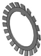
Les rondelles-freins sont des éléments de fixation simples, stables et fiables. La rondelle s'engage dans une rainure de l'arbre et bloque l'écrou en position si une de ses dents est repliée dans une des encoches situées sur la circonférence de l'écrou. Les rondelles-freins sont utilisées avec les écrous de serrage des séries KM et KML ainsi qu'avec les écrous N et AN pour les dimensions en pouces.
