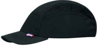
Une protection de la tête selon EN 812, à la mode baseball, avec rembourrage en mousse. La casquette VOSS-Cap a été élaborée de façon ergonomique et moderne, livrable en plusieurs couleurs. Sous la casquette en tissu se cache une coque en ABS, avec des orifices de ventilation avec grillage pour empêcher tout corps étranger de pénétrer à l'intérieur de celle-ci.
