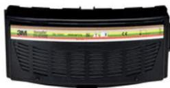
Pour masques respiratoires 3M série 6000 et 7000. Dans une cage de matière plastique, emboîtement à baïonnette. Filtre de grande puissance contre les particules solides ainsi que les aérosols liquides et pas volatils jusqu'à 30 fois la valeur VME/TLV.
