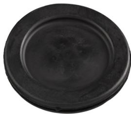
Le passe-fils à membrane DG est livrable dans les 10 grandeurs mentionnées pour des alésages [B] de  $\varnothing$  15.5 jusqu'à 79 mm. Il convient d'une part à obstruer les sorties de câbles sur des armoires de distribution, machines et appareils, et d'autre part, comme traversée pour câbles, conduites et tubes de diamètres quelconques jusqu'à 48 mm. Il suffit de découper la membrane en conséquence.
