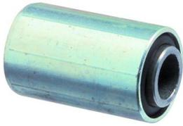
Ces éléments élastiques, à usages multiples, se composent d'une masse en caoutchouc naturel enfermée sous une pression élevée entre deux tubes d'acier cylindriques. Du fait de la précontrainte exercée, le tube intérieur peut être soumis par rapport au tube extérieur à une torsion élevée, sans pour autant provoquer un déplacement du caoutchouc.
