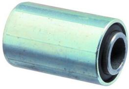
Ces éléments élastiques, à usages multiples, se composent d'une masse en caoutchouc naturel enfermée sous une pression élevée entre deux tubes d'acier cylindriques. Du fait de la précontrainte exercée, le tube intérieur peut être soumis par rapport au tube extérieur à une torsion élevée, sans pour autant provoquer un déplacement du caoutchouc.
