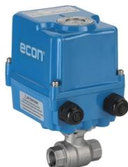
Le robinet à boisseau sphérique & voies à commande électrique est configuré selon les principes de base suivants: le fluide est de l'eau, la température du fluide est de 100°C maximum, le robinet à boisseau sphérique est actionné au moins quelques fois par jour, la conception de l'actionneur est conforme au standard Eriks.
