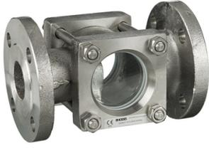
Edelstahl Schauglas mit Flanschanschluss, Druckklasse PN16 oder PN40.
