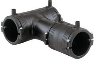
**Merkmale****Serie:** 281**Form:** T-Stück Reduzier**Material:** PE-100**Anschluss:** Elektroschweissen**Winkel des Bogens:** 90 °**Anschluss 2 Werkstoff:** PE-100**Anschluss 3 Werkstoff:** PE-100
