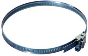
Schlauchschelle mit Schneckentrieb und aufgebogenen Bandkanten. Aufklappbarer Schnellverschluss. Schraube Sechskant mit Schlitz/Kreuzschlitz Stahl verzinkt.
