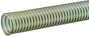
Für Absaugung und Transport von Sand, Kies, Getreide und andere Medien, welche höchste Anforderungen an Abriebfestigkeit und Standzeit stellen. Ideal für Silofahrzeuge und Verladebetriebe. Federstahldrahtspirale, dreh- und verschiebefest eingegossen.
