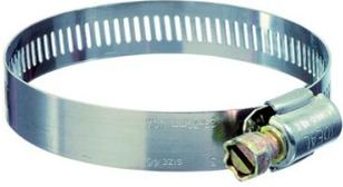
Schlauchschelle mit Schneckentrieb und gelochtem Band. Die Umbördelung ermöglicht auch mit dem Schraubenzieher ein sicheres Anziehen ohne Abrutschen. Ausführung: Sechskant mit Schlitz - bis 100 mm mit Umbördelung, ab 114 mm ohne Umbördelung.
