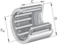
Nadelhülsen und Nadelbüchsen sind Nadellager kleinster radialer Bauhöhe. Sie bestehen aus spanlos geformten, dünnwandigen Außenhülsen und Nadelkränzen, die zusammen eine Baueinheit bilden. Diese Lager ermöglichen besonders raumsparende und montagefreundliche Lagerungen mit hoher Tragfähigkeit.
