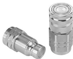
Flachdichtende Steckkupplungen der Serie FH aus Edelstahl V4A bestehen aus einem Kupplungsstecker und einer Kupplungsmuffe und dienen dazu, Rohr- und Schlauchleitungen schnell und einfach von Hand, also ohne Werkzeug, zu kuppeln und entkuppeln.
