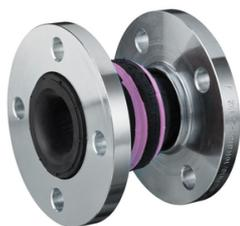
Typ 51 – Dieser Gummikompensator ist ein flexibles Modell mit flacher Welle wie bei Typ 50. Dieser Kompensator wird in der chemischen Industrie eingesetzt, wo neben einer hohen chemischen Beständigkeit auch hohe Temperaturen eine Rolle spielen.
