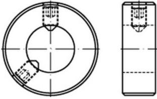
Diese Einstellringe sind mit Gewindestiften mit Innensechskant nach ISO 4029 (DIN 916) ausgestattet. Einstellringe mit  $d_1 \leq 70$  haben eine Einstellschraube, Ringe mit größeren Durchmessern haben zwei Einstellschrauben.
