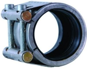
Nicht zugfeste Rohrkupplungen für alle Rohrmaterialien. Je nach Öffnung unterstützen die Kupplungen einen Biegewinkel von 2° bis 4° und eine axiale Bewegung von 10 mm. Bei der Montage müssen die Verschlusschrauben mit dem korrekten Drehmoment angezogen werden. Das erforderliche Drehmoment ist auf der Kupplung angegeben.
