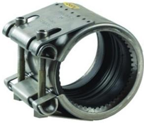
Zugfeste Rohrkupplung für Metallrohre. Zusätzliche Gewichtseinsparung einer leichteren Ausführung. Je nach Öffnung unterstützen die Kupplungen einen Biegewinkel von 2° bis 5°. Bei der Montage müssen die Verschlusschrauben mit dem korrekten Drehmoment angezogen werden. Das erforderliche Drehmoment ist auf der Kupplung angegeben.
