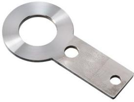
Distanzscheibe sind oft fest im Rohrleitungssystem montiert (als Abstandshalter). Der Vorteil ist, dass diese Distanzscheibe bei Montagezeit gegen (Druck-) Spaten ausgetauscht werden können. Distanzscheibe werden auch Ring Spacer genannt.
