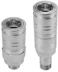
Push/Pull Steckkupplungen der Serie UX bestehen aus einer Kupplungsmuffe in einer kurzen oder langen Version und dienen dazu, Rohr- und Schlauchleitungen schnell und einfach von Hand, also ohne Werkzeug, zu kuppeln und entkuppeln. Die Muffe kann unter vollem Betriebsdruck im Stecker gekuppelt werden und als Abreißkupplung installiert werden.
