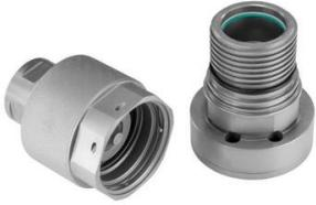
Schraubkupplungen der Serie PS bestehen aus einer Kupplungsmuffe mit Außengewinde und einem Kupplungsstecker mit Schraubhülse. Entwickelt wurde die Serie für besonders schwere Hammer-Anwendungen und für die Verbindungen von verschiedenen Auslegern in Abbruchmaschinen zum Anschluss von Hydraulikleitungen in DN25 (1 1/4").
