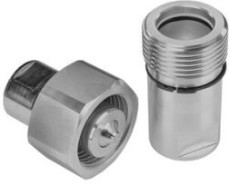
Schraubkupplungen der Serie HR bestehen aus einer Kupplungsmuffe mit Außengewinde und einem Kupplungsstecker mit Schraubhülse. Die Serie wurde für besonders schwere, hochdruckbelastete und hochpulsierende Anwendungen zum Anschluss von Hydraulikleitungen bis DN38 (1 1/2") entwickelt.
