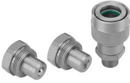
Schraubkupplungen der Serie HI bestehen aus einer Kupplungsmuffe mit Schraubhülse und einem Kupplungsstecker mit Außengewinde. Entwickelt wurde die Serie für Hochdruck-Anwendungen nach ISO 14540 und kann unter Restruck gekuppelt werden.
