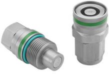
Flachdichtende Schraubkupplungen der Serie FG bestehen aus einer Kupplungsmuffe mit Schraubhülse und einem Kupplungsstecker mit Außengewinde. Entwickelt wurde die Serie für besonders schwere Anwendungen zum Anschluss von Hydraulikleitungen bis DN31,5 (1 1/4").
