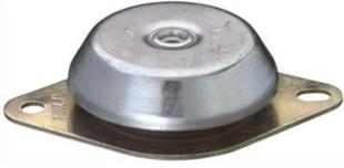
Le support industriel RA/RA-EM convient pour de nombreuses applications. Le type RA/RA-EM résiste aussi bien à la compression qu'au cisaillement. Le support est stable grâce à sa hauteur limitée. Protection contre les projections d'huile par la forme cloche de la coiffe et résistant au cisaillement par des limiteurs de mouvements ["stop"]. Nombre de tours: à partir de 900 t/min. Livrable en 40 ou 60 shore A.
