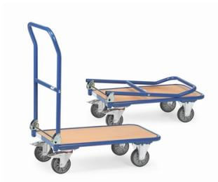
Par exemple: Chariots en tube d'acier, revêtement époxy avec plate-forme en mélaminé surface effet hêtre. Dossier de poussée rabattable sur la plate-forme. 2 roues pivotantes et 2 roues fixes à bandage caoutchouc, moyeu à roulement à rouleaux. Freins sur roues pivotantes.
