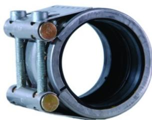
Raccord non résistant à la traction pour tous les matériaux de tube. Selon l'ouverture, les raccords peuvent supporter un angle de courbure de 2° à 5° et un mouvement axial de 5 mm. Lors du montage, il convient d'appliquer le couple correct sur les vis d'obturation. Le couple est indiqué sur le raccord.
