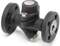
La série ADCA TH32YLC est un purgeur thermostatique en acier de faible capacité, équipé d'un filtre intégré et d'une excellente purge. Il est spécialement conçu pour des applications avec des équipements de process tels que les chaufferies, les stérilisateur, les équipements alimentaires, chimiques et de lavage.
