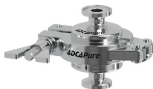
La série AdcaPure TSS6 est un purgeur de vapeur thermostatique et un purgeur d'air entièrement en acier inoxydable, spécialement développé pour les applications avec de la vapeur "propre" ou "pure" utilisée dans les systèmes de vapeur tels que les réacteurs à vapeur, les stérilisateurs et les lignes de distribution de vapeur, entre autres, et est idéal pour une utilisation dans les skids de vapeur propre.
