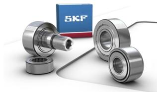
Les galets-support sont dans leur principe des roulements à aiguilles ou à rouleaux cylindriques à bague extérieure épaisse. La surface extérieure de la bague extérieure est bombée afin d'empêcher les charges de bord en cas de déversement ou lorsque le galet fonctionne en position inclinée. Ce sont des ensembles prêts à monter et pré-graissés, conçus pour tous les types de mécanismes à cames, convoyeurs etc.
