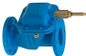
Fonte nodulaire, clapet anti-tempête en forme droit, dispositif de blocage avec joint NBR et raccord à bride, pression nominale PN4.
