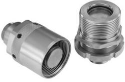
Flachdichtende Schraubkupplungen der Serie RH bestehen aus einer Kupplungsmuffe mit Außengewinde und einem Kupplungsstecker mit Schraubhülse. Entwickelt wurde die Serie für besonders schwere Anwendungen zum Anschluss von Hydraulikleitungen bis DN25 [1"].
