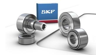
SKF Stützrollen sind Nadel- bzw. Zylinderrollenlager mit einem dickwandigen Aussenring. Die Mantelfläche am Aussenring ist profiliert, was Kantenspannungen bei Verkippungen oder Schräglauf vermindert. Sie sind einbaufertig, mit Schmierfett befüllt und zur unmittelbaren Verwendung in allen Arten von Kurvengetrieben, Führungsbahnen, Förderanlagen usw. geeignet.
