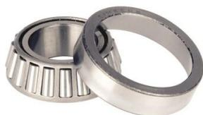
Kegelrollenlager haben kegelig ausgeführte Laufbahnen im Innen- und Aussenring, zwischen denen kegelige Rollen angeordnet sind. Die Scheitelpunkte aller Kegelflächen treffen sich in einem gemeinsamen Punkt auf der Lagerachse. Kegelrollenlager sind deshalb besonders zur Aufnahme kombinierter (radial und gleichzeitig axial wirkender) Belastungen geeignet. Kegelrollenlager sind im Allgemeinen nicht selbsthaltend. Der Innenring mit Rollen und Käfig kann getrennt vom Aussenring eingebaut werden.
