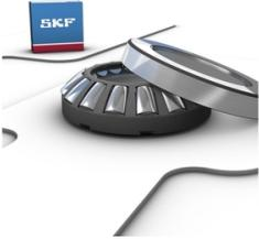
Axial-Pendelrollenlager haben besonders gestaltete Laufbahnen und asymmetrische Rollen. Sie können Axialbelastungen in einer Richtung aufnehmen aber auch Radialbelastungen bei gleichzeitig wirkenden Axialbelastungen. Die Belastungen werden schräg zur Lagerachse von einer Laufbahn auf die andere übertragen. Ein Bord an der Wellenscheibe führt die Rollen
