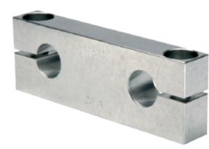
Bei Wellenträgern unterscheidet man zwischen Wellenböcken und Wellenunterstützungen. Während die Wellenböcke die Wellen nur an deren Enden eingespannt tragen, werden Wellenunterstützungen üblicherweise auf der gesamten Wellenlänge eingesetzt und bedingen daher die Verwendung offener Linearlagereinheiten. Die Tandem-Wellenböcke LEBS passen zu den Duo- und Quadro-Linearlagereinheiten mit eingebauten Linearkugellagern der ISO-Serie 1 und sind für Wellendurchmesser von 12 bis 50 mm lieferbar.
