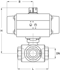
Das druckluftbetriebene 3-Wege-Kugelventil ist nach folgenden Grundprinzipien konfiguriert: pneumatischer Steuerdruck bei 6&nbsp;bar, Medium ist Wasser, Mediumtemperatur beträgt maximal 100&nbsp;°C, Kugelventil wird täglich mindestens ein paar Mal betätigt, Antriebsaufbau gemäß Eriks-Standard.
