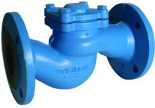
**Merkmale****Typ:** 101**Norm:** EN (DIN)**Bauform:** Gerade**Material Gehäuse:** Grauguss**Werkstoffqualität:** EN-JL1040**Oberflächenschutz:** Standard Farbanstrich**Anschluss:** Flansch**Flanschbearbeitung:** Dichtleiste**Baulänge nach Norm:** EN 558, Reihe 1**Mit Feder:** Ja
