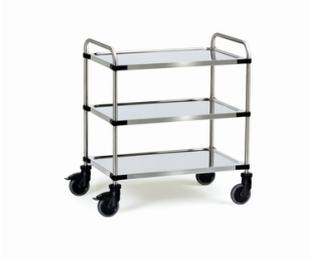
Zum Beispiel: Etagenwagen mit Rohrschiebebügel aus CNS (Chrom-Nickel-Stahl) und tiefgezogenen Böden CS (Chrom-Stahl) mit umlaufendem Rand, schalldämmend unterfüttert. Kantenschutzecken und Abweiserrollen. Rostfreie Rollen gemäß DIN 18867 Teil 8. 4 Lenkrollen, elastisch und leicht laufend, spurlos. Naben mit Kugellager, 2 Lenkrollen mit Feststeller. Zerlegte Anlieferung, leichte Selbstmontage. Tragkraft pro Etage 80 kg.
