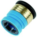
Für die Verbindung eines Rohres mit einem Verteilerblock. Für den Einsatz der Patronen müssen entsprechende Aufnahmebohrungen im Block vorhanden sein. Vorgefettete und geschützte Dichtung (NBR). Automatische Zentrierung der Patrone und automatische Montage möglich. Entspricht der Norm ISO 14743 und ist RoHS-konform.
