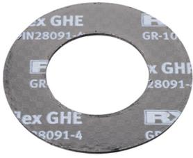
**Merkmale****Serie:** EGRAFLEX**Typ:** GHE**Norm:** ASME B16.21**Reinheit Grafit:** >98 %**Material Einlage:** RVS 316 L [1.4404]**Ausführung Einlagen:** Spiessblech**Anzahl Einlagen:** 1**Anti-stick:** Nein**Temperaturbereich:** -200 / 450 °C**Max. Druck:** 100 bar**Merkmale [2]**
