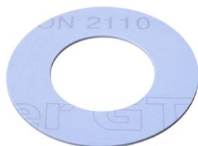
**Merkmale****Serie:** CLIPPERLON**Typ:** 2110**Norm:** ASME B16.21**Materialstruktur:** PTFE, modifiziert**Markierung:** Mit Druck**Temperaturbereich:** -210 / 240 °C**Max. Druck:** 40 bar
