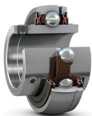
SKF Y-Lager, in der Norm werden sie Spannlager genannt, basieren auf abgedichteten Rillenkugellagern der Reihen 62 bzw. 63 mit kugelig ausgeführter Aussenringmantelfläche. Sie werden serienmässig in verschiedenen Baureihen und Grössen gefertigt. Sie haben entweder einen normalen, in der Hauptsache aber einen ein- bzw. beidseitig verbreiterten Innenring.
