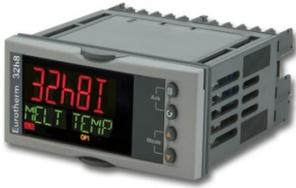
Digitale Prozessanzeige der Serie 32h8i mit Alarmfunktion, Übermittlerversorgung, Kommunikationsinterface und analoger Transmission erneuerung. Verfügt über eine 6-Segment-Linearisierung zur Füllstandsmessung von nichtlinearen Messungen in Tanks.
