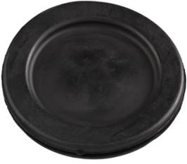
Die Membrandurchführungstüllen DG sind in den zehn aufgeführten Grössen für Blechbohrungen (B) von  $\varnothing$  15.5 bis 79 mm lieferbar. Sie dienen einerseits zum Verschliessen von Kabelausgängen an Schaltschränken, Maschinen und Apparaten, und andererseits sind sie zur Durchführung von Kabeln, Leitungen und Rohren beliebigen Durchmessers bis 69 mm geeignet, wenn die Membranen entsprechend ausgestanzt werden.
