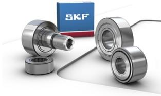
SKF Stützrollen sind Nadel- bzw. Zylinderrollenlager mit einem dickwandigen Aussenring. Die Mantelfläche am Aussenring ist profiliert, was Kantenspannungen bei Verkipnungen oder Schräglauf vermindert. Sie sind einbaufertig, mit Schmierfett befüllt und zur unmittelbaren Verwendung in allen Arten von Kurvengetrieben, Führungsbahnen, Förderanlagen usw. geeignet.
