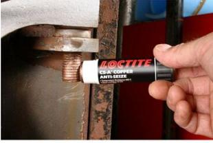
Anti-Seize à base de cuivre. Applications usuelles : vis, écrous, canalisations, boulons d'échappement et d'étrier de frein
