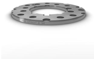
Les rondelles de butée SKF sont des butées autolubrifiantes composites destinées à des montages axialement compacts, pour un guidage axial lorsqu'un mouvement d'oscillation et de rotation est possible. Elles conviennent à toutes les applications pour lesquelles une certaine liberté de maintenance est requise et où peut survenir une insuffisance de lubrifiant.
