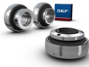
Les roulements Y SKF, généralement appelés roulements « insert », sont des roulements rigides à billes protégés des séries 62 et 63 qui présentent une surface extérieure sphérique convexe. Ces roulements sont fabriqués dans des tailles et des séries variées et sont disponibles avec une bague intérieure standard ou débordante d'un côté ou des deux côtés.
